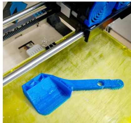
Schicht für Schicht wächst ein Bauteil für den Roboterarm auf dem Drucktisch
