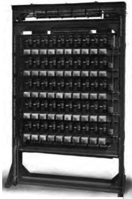
Bild 23: Wählergestell für Landfernsprechzentrale-Vorwählerrahmen
