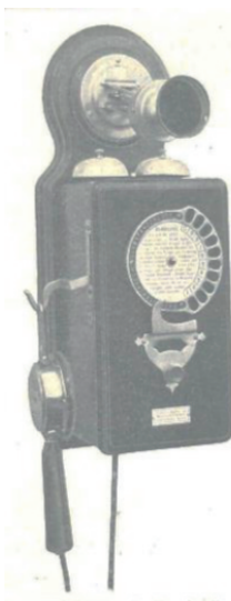
Bild 15: Wandgehäuse für Sprechstellen
