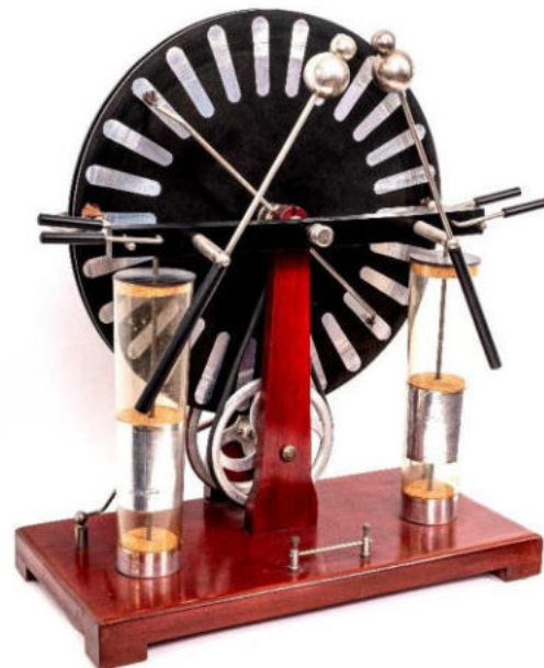
Bild 20: Eine als Lehrmittel ausgestaltete Influenzmaschine nach Wimshurst /Holtz/Toepler; hergestellt von Voltana, Deutschland, um 1935. Im Vordergrund die innen und außen metallbelegten Glaszylinder („Leydener Flaschen“) als zu- und abschaltbare hochspannungsfeste Stützkapazität für die elektrische Last. /Privatbesitz des Verfassers/
