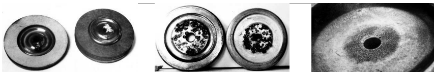
Bild 9: Platten der Löschkunfenstrecken von Überspannungsableitern [18]
