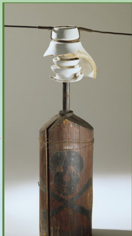
Mastkopf mit Isolator der Leitung Lauffen-Frankfurt von 1891 Sammlung des Deutschen Museums München
