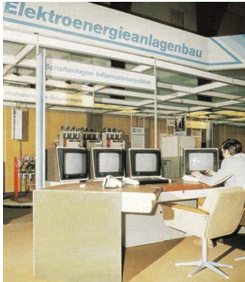
*Bild 76: Bedienarbeitsplatz der digitalen Leittechnik SIS/HS für Hochspannungs-Schaltanlagen, ausgestellt zur Leipziger Frühjahrmesse 1983*
