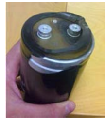
Zerstörter Zwischenkreis-kondensator einer USV
