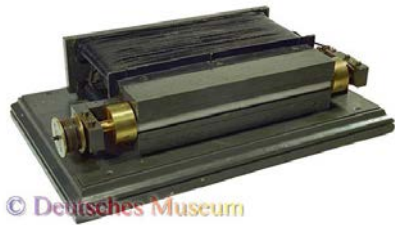
Bild 1: So sah der erste brauchbare selbsterregte Reihenschluss-Dynamo von Werner Siemens 1867 auf der Pariser Weltausstellung aus (Leistung ca. 25 W bei 4000 U/min). Quelle: Deutsches Museum Inv. Nr. 1927/59641
